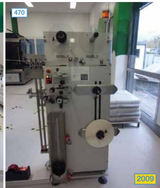
splice-unit for labeling-machine, make: BAUSCH & STRÖBEL, type: ESE 9752 / Spleißeinrichtung für Etikettierer, Fabrikat: BAUSCH & STRÖBEL, Typ: ESE 9752
