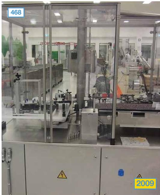
Ampulla-labeling-machine, make: BAUSCH & STRÖBEL, type: EFA 1025 / Ampullenetikettiermaschine, Fabrikat: BAUSCH & STRÖBEL, Typ: EFA 1025
