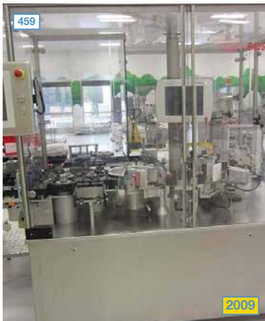
Carpulla-labeling-machine, make: BAUSCH & STRÖBEL, type: ESA 1025 / Carpullenetikettiermaschine, Fabrikat: BAUSCH & STRÖBEL, Typ: ESA 1025
